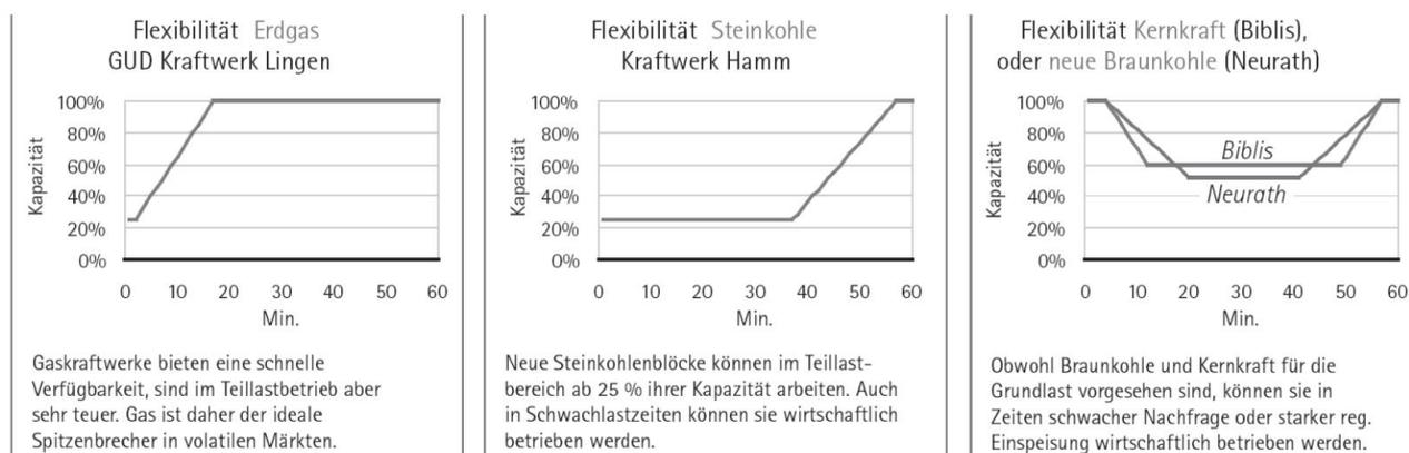
図 60：発電所の出力調整速度 [VGB]
